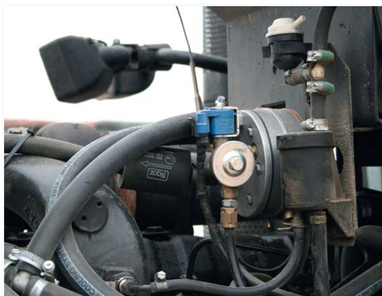
► Z nádrže jde plyn v kapalně fázi do reduktoru, v němž se ohřeje, zplynuje a vytvoří se potřebný tlak
